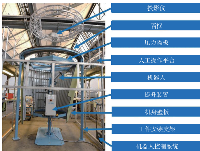
图14 ZeMA开发的A320第19机身段人机协同装配验证平台
