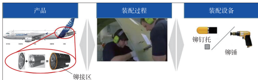
图13 A320座舱隔板与机身人工装配过程
