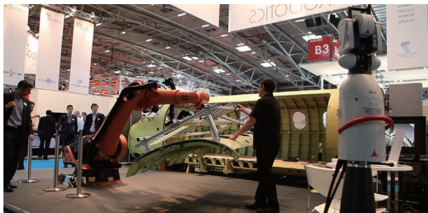
图15 协作机器人用于无型架飞机装配
